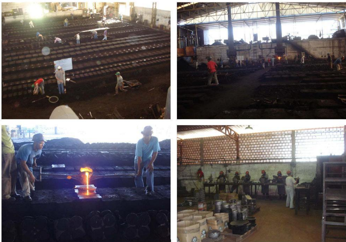
Figura 2 – Registro Fotográfico da produção de uma das empresas participantes do projeto. Nota-se o sistema de manufatura de baixa tecnologia e a produção semi-artesanal.
